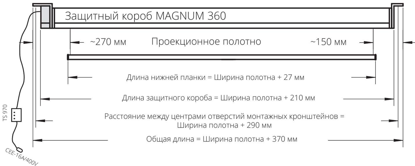
Кабель мотора 400В/16А вкл. блок управления TS 970 и силовой разъем CEE типа, длина кабеля 9 м
