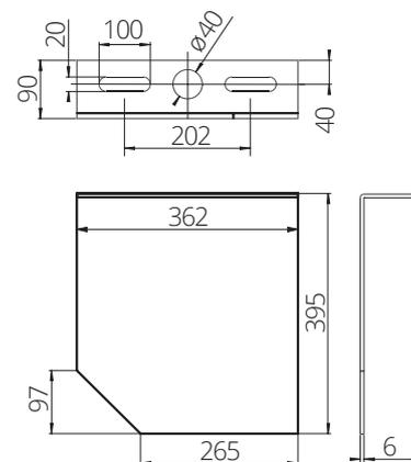
МОНТАЖНЫЕ КРЕПЛЕНИЯ ПРОЕКЦИОННОГО ЭКРАНА ДОЛЖНЫ БЫТЬ УСТАНОВЛЕНЫ НА НЕСУЩИЕ ЭЛЕМЕНТЫ ПОТОЛКА! ЗАПРЕЩАЕТСЯ РАЗМЕЩАТЬ КАКОЙ-ЛИБО ГРУЗ НА КОРОБЕ! НЕ ДОПУСКАТЬ ПЕРЕКОСОВ ВО ВРЕМЯ МОНТАЖА!
