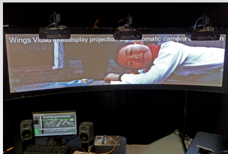
Kurzdistanzprojektoren an der Projektorenhalterung befestigt
